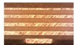
EZ-pure-0055H 显示出非常一致的层间电介质间距。根据要求, 可通过导体分析技术进行热循环分析。请咨询您当地的技术服务经理。
