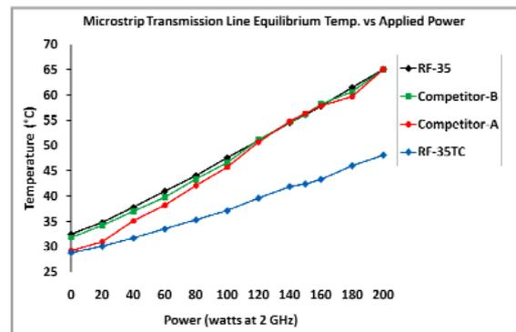
在 RF-35TC, RF-35 两种竞品材料上的微带传输线的施加功率函数的最高温度。
