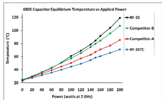
在 RF-35TC, RF-35 两种竞品材料上的微带和 0805 电容器的施加功率函数的最高温度。
