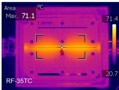
在施加 200 瓦功率的情况下，在 RF-35TC 上组装的，中心带有 0805 电容器 (47pF/250V/C0G) 的微带传输线的热图像。
