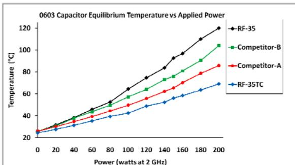
在 RF-35TC, RF-35 两种竞品材料上的微带和 0603 电容器的施加功率函数的最高温度
