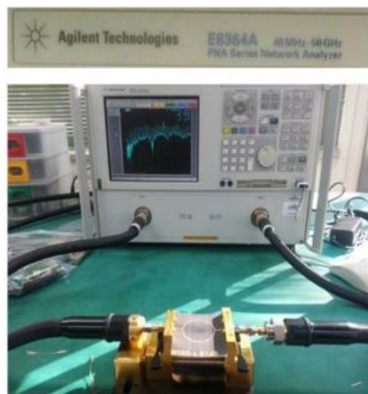
Agilent E8364A PNA 网络分析仪和通用试验夹具 3830 K(由 ANRITSU 提供)用于环形谐振器检测。
